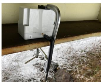
図2：センサユニットの橋桁への設置
